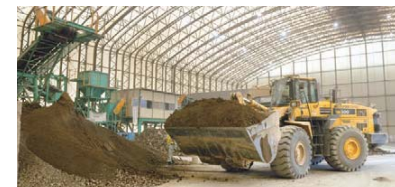
セメント原料化、加工作業
