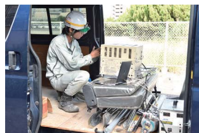
ガスクロマトグラフィ(土壌ガス現地分析)
