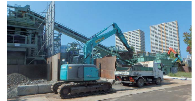
原位置浄化(土壌洗浄プラントの現場設置)
