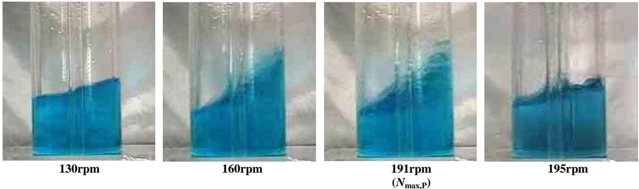
$N_{max,P}$  を境に、液面挙動が大きく変化し突然波高が下がる現象が観察され、それ以上では液自由表面の動きがほとんど観察されなかった。この時、槽内の液はほとんど混合されず、*Out of phase condition* であるため  $N_{max,P}$  以上の回転数で操作してはいけない。
