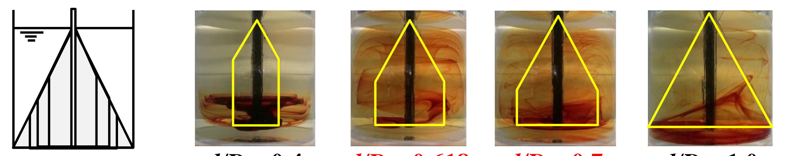
Fig.7 翼径の最適化 ( \mu = 0.087\text{Pa}\cdot\text{s} 10回転後)
