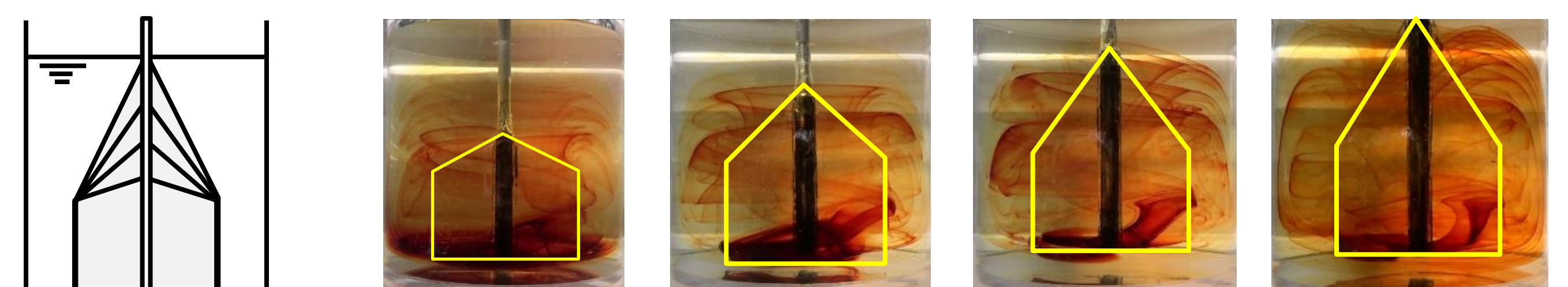
Fig.6 翼幅の最適化 ( \mu = 0.087\text{Pa}\cdot\text{s} 10回転後)
